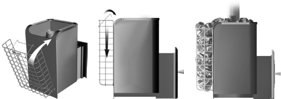
Рисунок-10. Установка сетки-каменки на печь.
