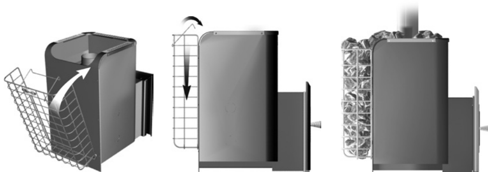
Рисунок -8. Установка сетки-каменки на печь.
