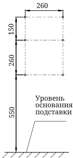
Рисунок 6. Схема отверстий под анкерные болты для крепления опоры к стене
